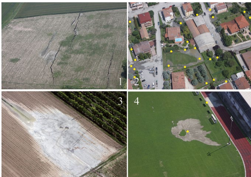
Figura 2. Esempi di effetti superficiali rilevati. 1. Fratture tensionali (fino a 1 metro in larghezza e 2 metri in profondità); 2. Eruzione di sabbie (indicate dai punti gialli) da pozzi, fratture e fondazioni nell'area di San Carlo; 3. Eruzione di sabbie in aree agricole, con formazione di crateri; 4. Eruzione di sabbia all'interno del campo sportivo di San Felice (Fonte: Bertolini, Fioroni, 2012).
