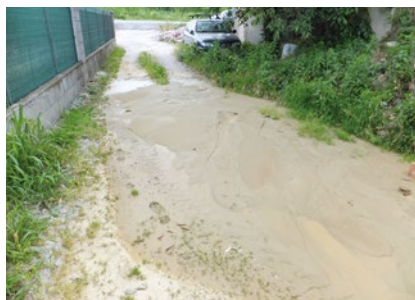
Figura 4. A sinistra, fratture nel terreno con fenomeni di liquefazione presso S. Carlo. (Ferrara) indotte dal sisma del 20 maggio 2012. A destra, vulcanetto di sabbia per fenomeno di liquefazione indotto dal sisma del 29 maggio 2012 presso Moglia di Gonzaga (Mantova).
